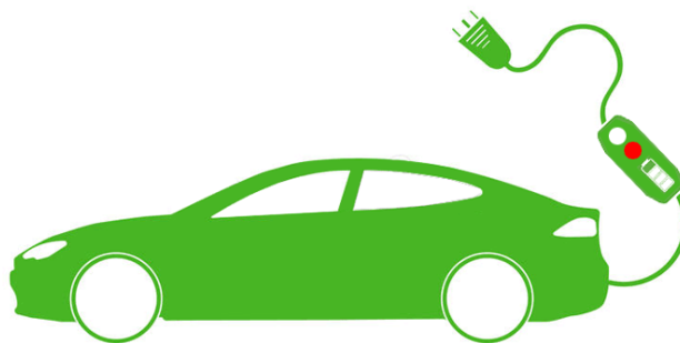
Рисунок 2.6 - Зарядка с применением зарядного кабеля с блоком защиты
